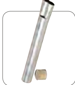
Caja de anclaje en acero galvanizado. Ø ext.: 70 mm. Ø int.: 65 mm. Altura: 60 cm. Peso: 4 kg.
