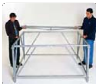
3 - Colocación del travesaño soporte de las planchas.
