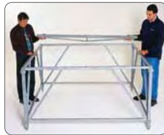
3 - Colocación del travesaño soporte de las planchas.
