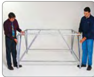
2 - Ensamblaje del marco y postes para formar los módulos de 2 x 2 m. Ajuste de las roscas.
