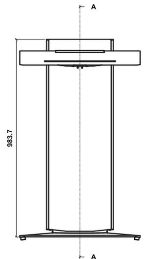
Estructura y base realizada en placha metálica y pieza de fundición, acabado pintado en color negro o blanco.
